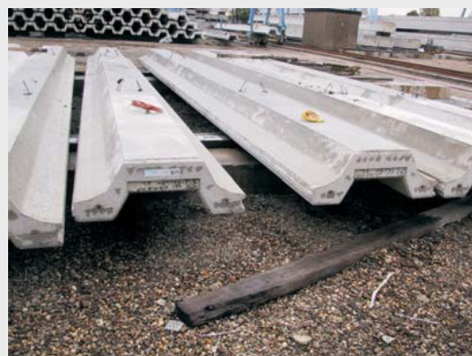
Damwanden voorzien van sensoren
